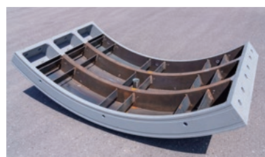
中詰コンクリート打設前
